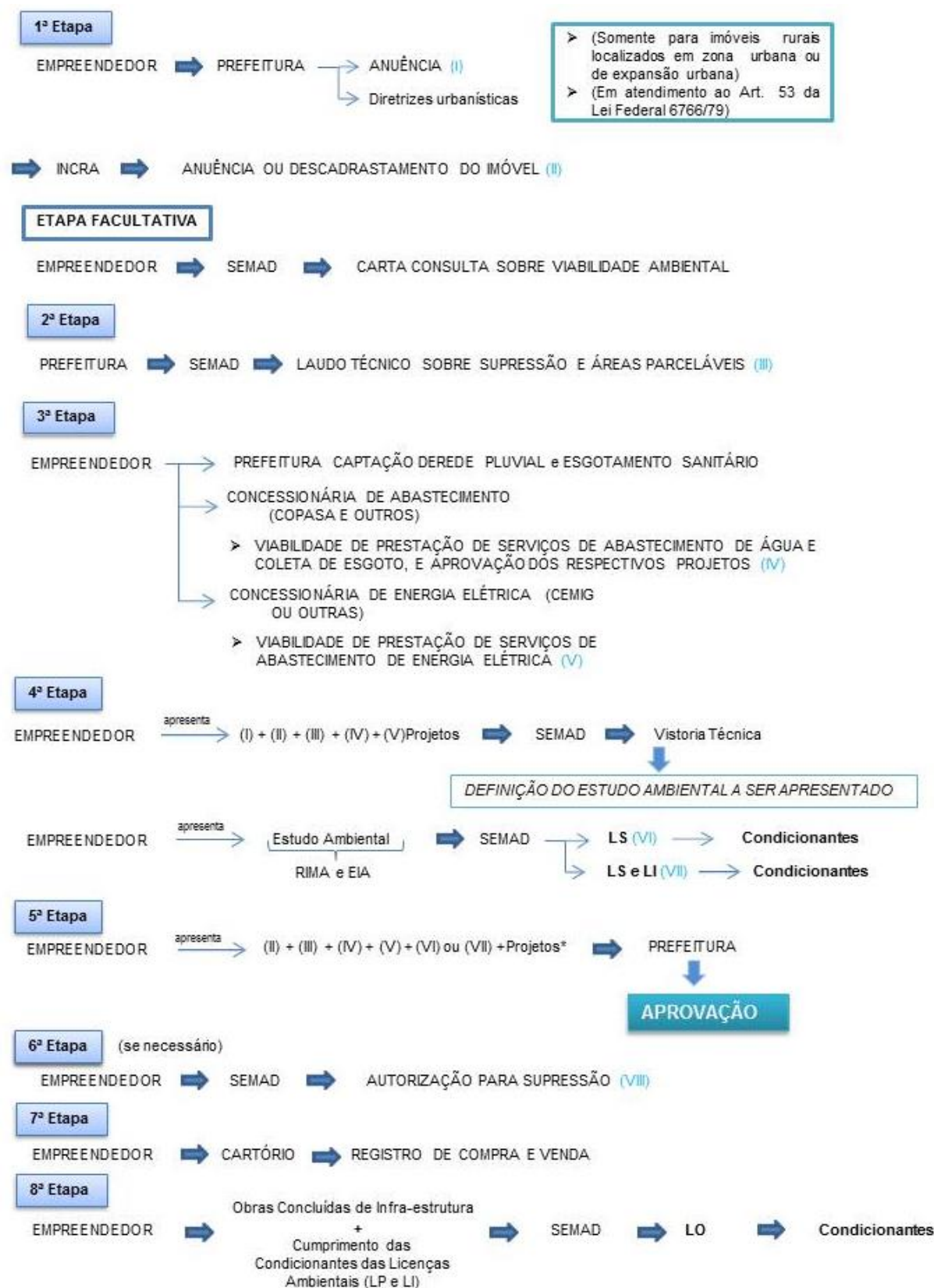
Figura 36: Fluxograma do procedimento para a aprovação do loteamento
