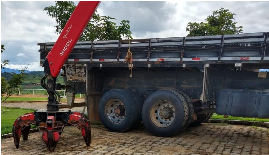
Figura 11 – Grua utilizada na retirada das macrófitas.
