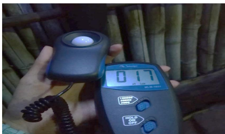
Figura 41 - Teste de lux realizado na primeira montagem no Bairro Santa Efigênia.
