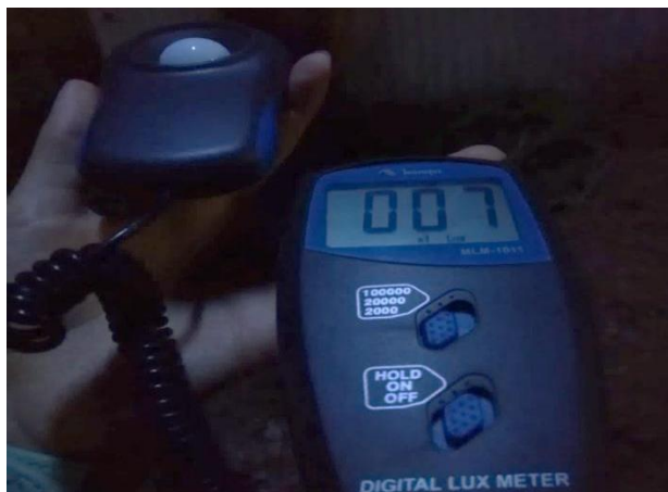
Figura 25 - Valor apresentado no luxímetro após medição no poste instalado na residência.
