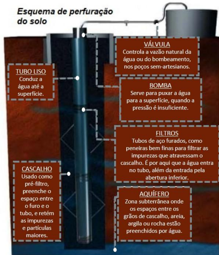
Figura 10 – Poço artesiano
