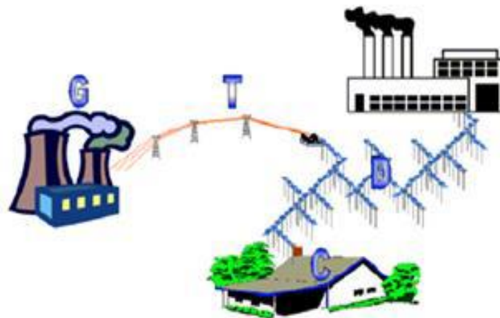
Figura 1 – Geração, transmissão e distribuição
