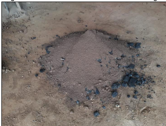
Figura 13: Mistura da cinza do lodo com a argila
