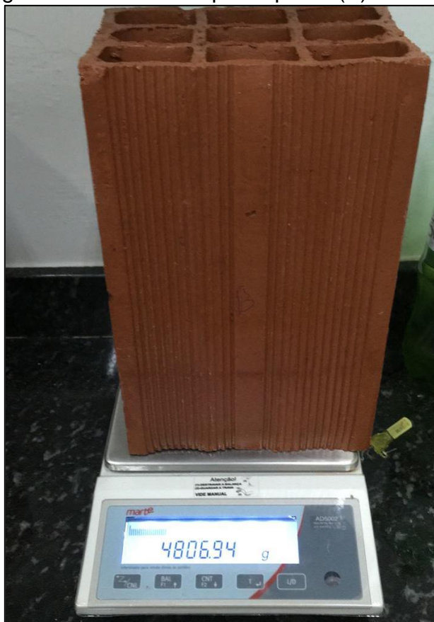
Figura 23: Peso do corpo de prova (A) molhado
