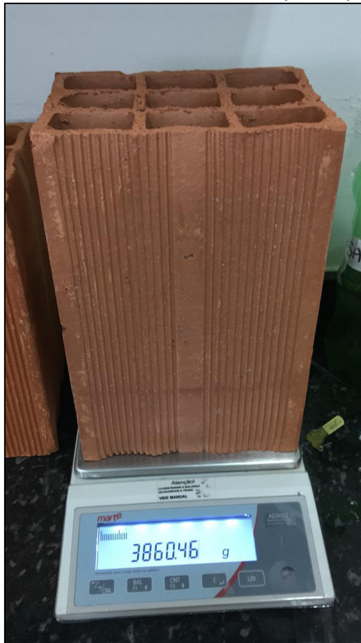
Figura 24: Peso massa seca do corpo de prova (B)
