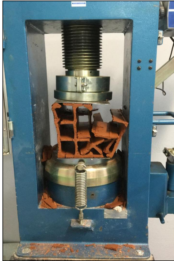
Figura 26: Tijolo sendo prensado
