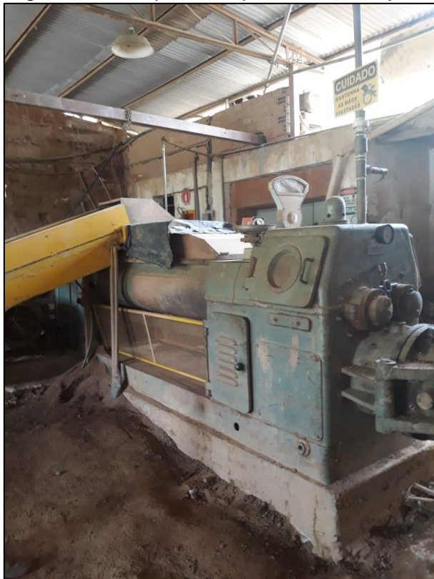
Figura 12: Maquinário que molda os tijolos
