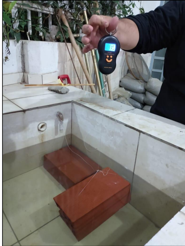
Figura 25: Pesagem do corpo de prova (C) imerso
