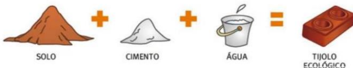
Figura 2.2 – Composição do tijolo solo-cimento
