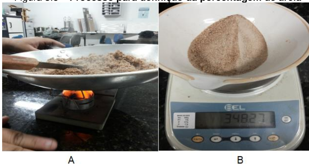
Figura 3.6 – Processo para definição da porcentagem de areia
