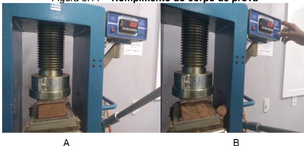
Figura 3.11 – Rompimento do corpo de prova
