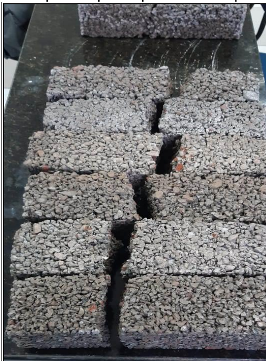
Figura 3.17: Corpos de prova prismáticos após rompimento
