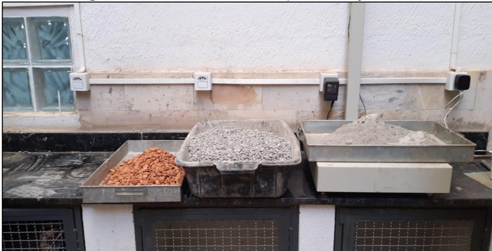
Figura 3.4: Materiais usados para o traço 90% brita
