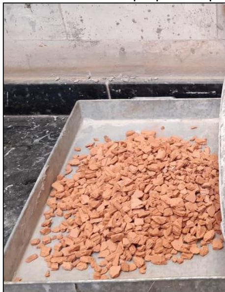
Figura 3.3: Material reciclado preparado para a mistura
