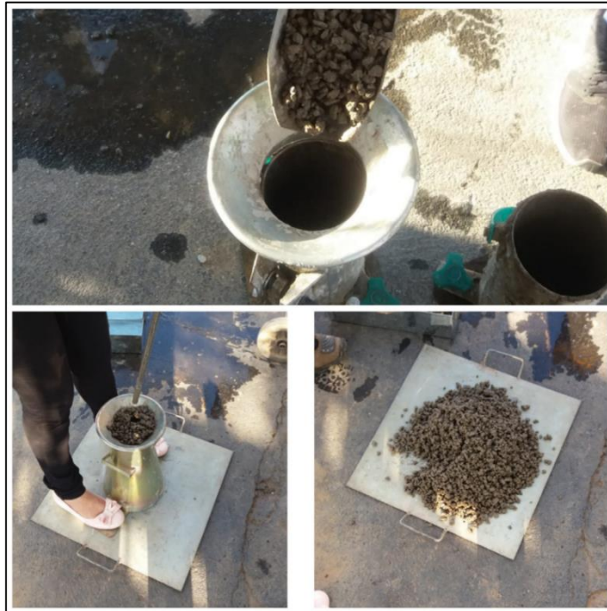
Figura 3.12: Procedimento de ensaio Abatimento do tronco de cone
