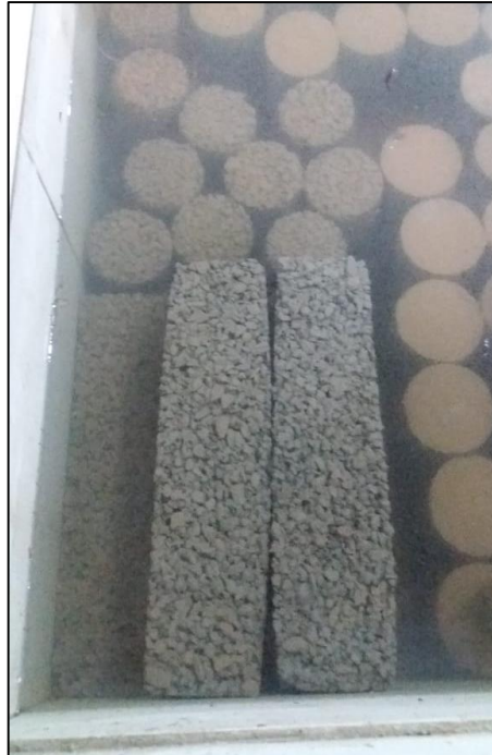
Figura 3.9: Corpos de prova em câmara úmida
