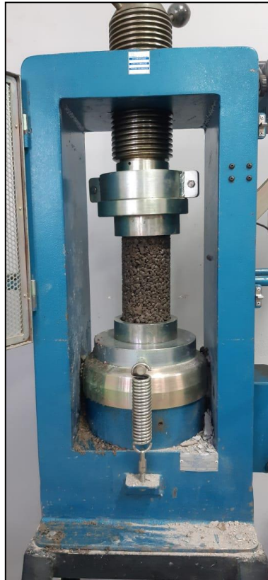
Figura 3.18: Rompimento de corpos de prova cilíndricos.
