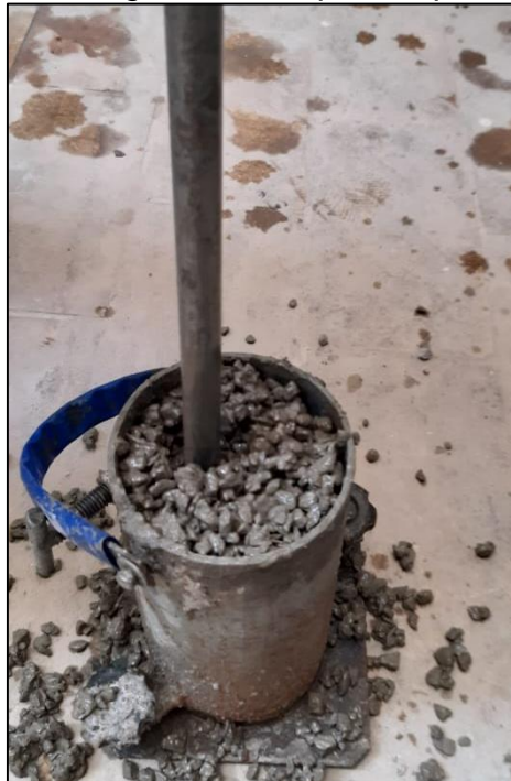
Figura 3.6: Moldagem dos corpos de prova cilíndricos
