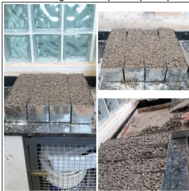
Figura 3.15: Moldagem de corpos de prova prismáticos.
