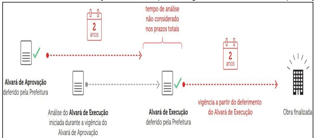
Figura 5– Alvará de execução emitido após a vigência do Alvará de aprovação
