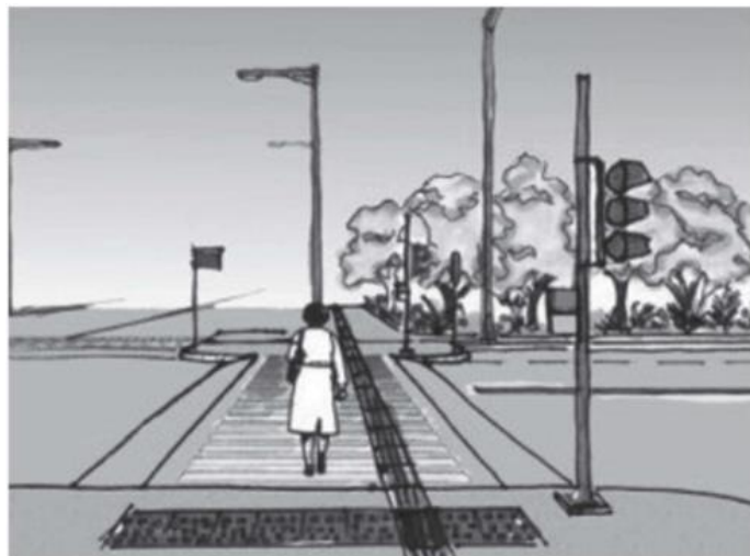
Figura 6: Travessia elevada com semáforo para pedestre
