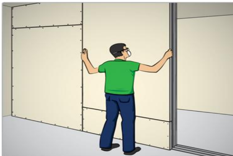
FIGURA 4: Amarração das chapas de gesso
