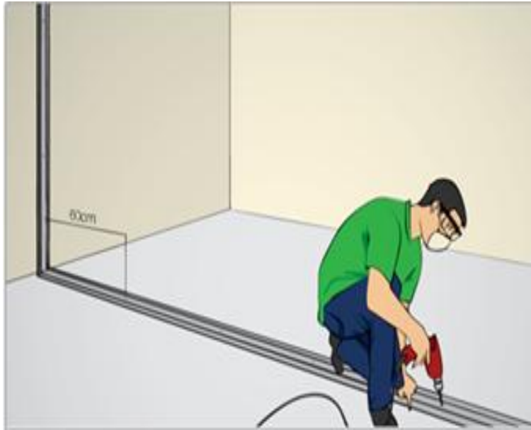
FIGURA 1: Instalação das guias
