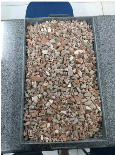
Figura 7: Material britado no britador de mandíbula
