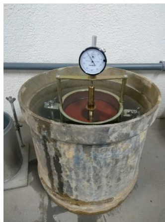
Figura 8: Corpo de prova em imersão após compactação
