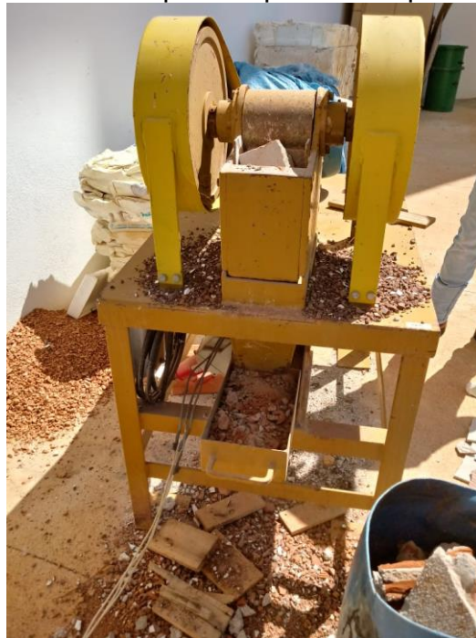
Figura 6: Britador utilizado para a quebra das partículas dos RCDs
