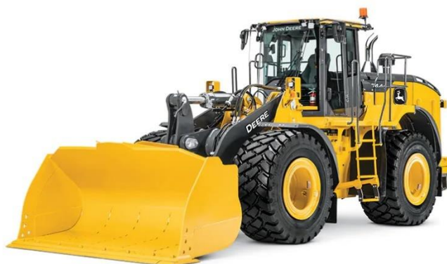
FIGURA 4: PÁ CARREGADEIRA DE PNEU
