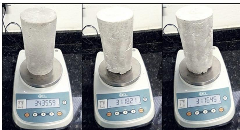
**Figura 30:** Aferição das massas secas: (a) Corpo de prova I, (b) Corpo de prova II e (c) Corpo de prova III.
