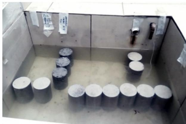
**Figura 26:** Corpos de prova para cura por imersão no período de 7 dias
