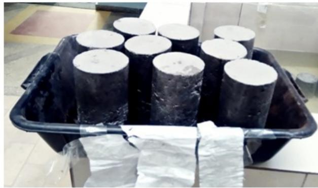
**Figura 27:** Corpos de prova após a retirada do tanque
