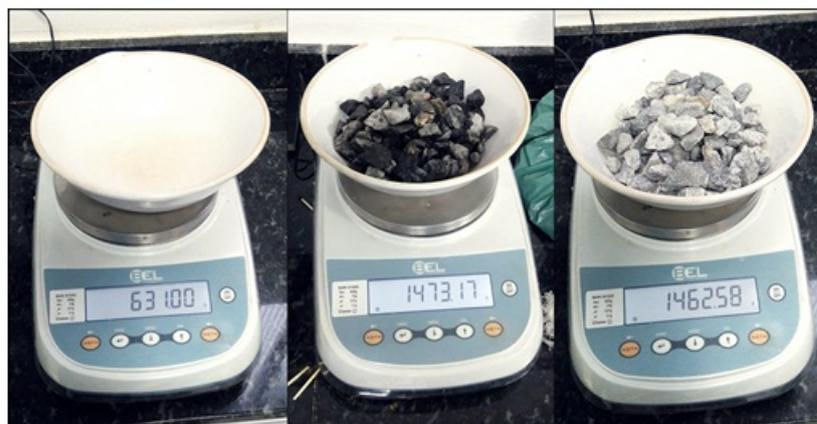
**Figura 15:** Aferição das massas: (a) recipiente, (b) brita saturada com superfície seca e (c) brita seca.
