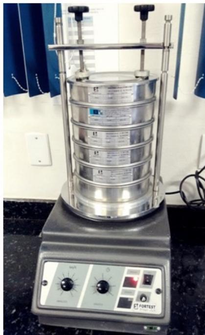
**Figura 6:** Conjunto de peneiras e agitador mecânico.
