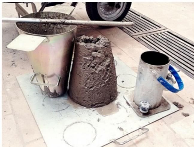
**Figura 23:** Medida do abatimento do concreto da segunda dosagem
