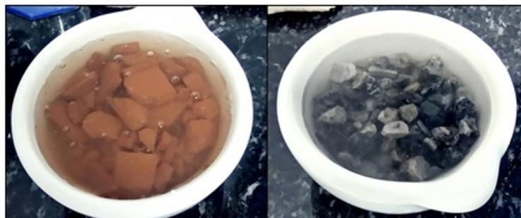
**Figura 13:** Submersão dos agregados graúdos: reciclado cerâmico e brita, respectivamente.
