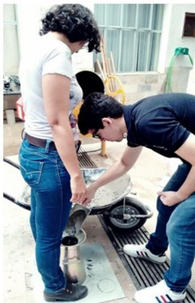
**Figura 21:** Preenchimento do molde em três camadas, segurando firmemente a aleta da placa.
