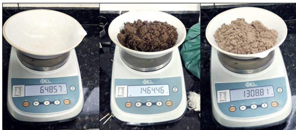
**Figura 12:** Aferição das massas: (a) recipiente,(b) areia saturada com superfície seca e (c) areia seca.
