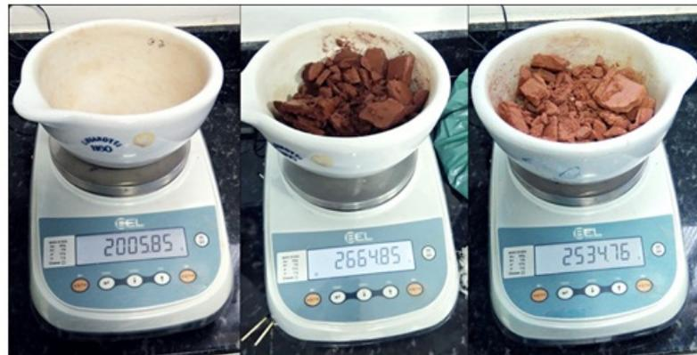
**Figura 14:** Aferição das massas: (a) recipiente, (b) agregado reciclado cerâmico saturado com superfície seca e (c) agregado reciclado seco.
