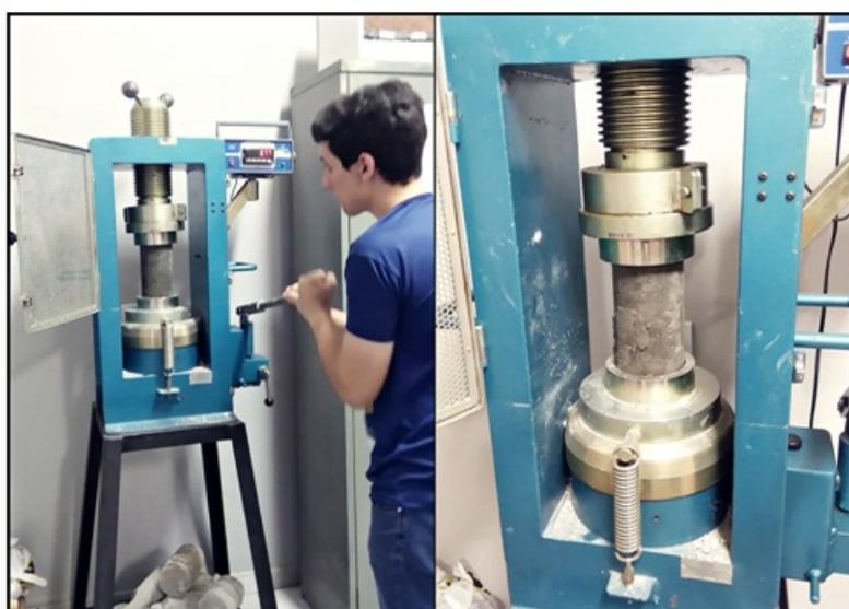
**Figura 28:** Rompimento dos corpos-de-prova
