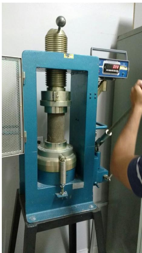
**Figura 16:** Prensa Manual para os ensaios de compressão do concreto.
