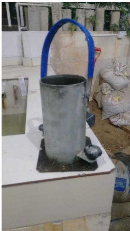
**Figura 14:** Fôrma cilíndrica para moldar os corpos de prova.
