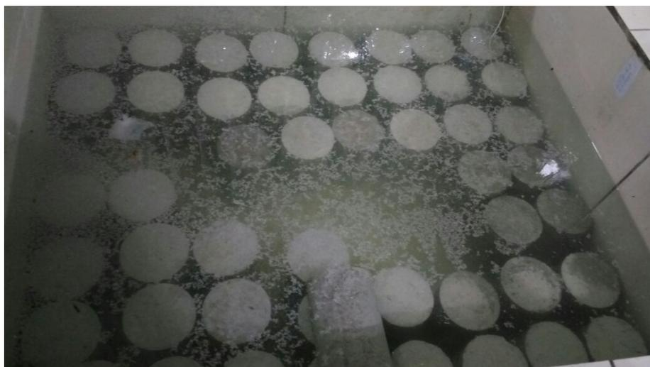
**Figura 13:** Tanque para armazenamento dos corpos de prova.
