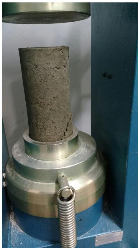
**Figura 17:** Amostra após o rompimento em 7 dias.
