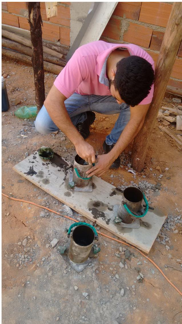
**Figura 10:** Revestimento dos moldes com óleo mineral.
