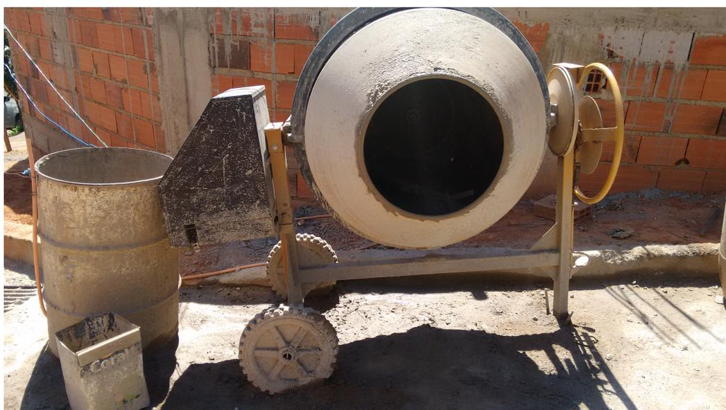
**Figura 7:** Betoneira com a mistura de água e cimento.
