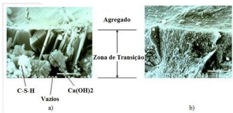
**Figura 6:** Zona de transição agregado - pasta de cimento.
