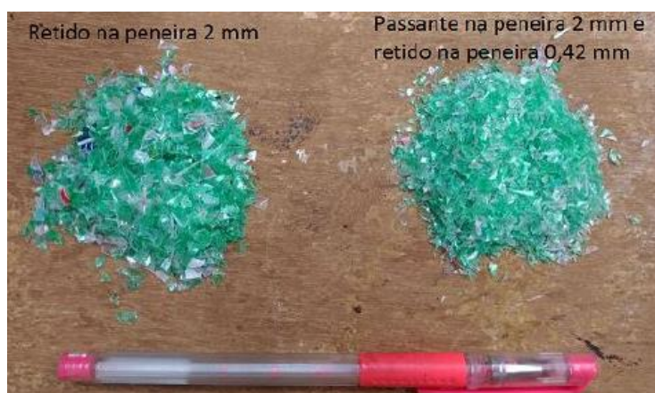
Figura 12 – Dimensões do pó de PET após peneiramento
