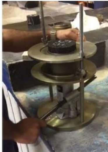
Figura 5 – Extração do corpo de prova do molde
