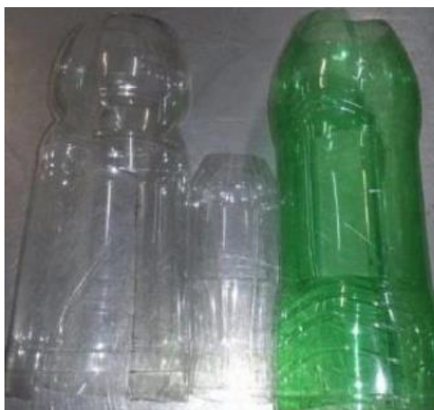
Figura 10 – Garrafas PET limpas com base e topo cortados
