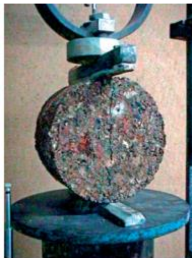
Figura 9 – Ensaio de Resistência à Tração por Compressão Diametral
