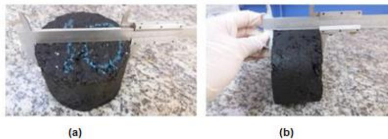
Figura 6 – (a) Medição do diâmetro e (b) altura do CP
