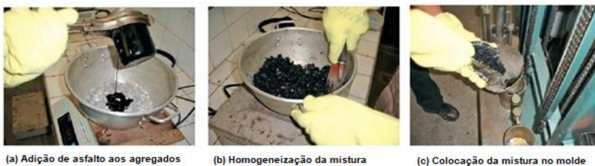
Figura 4 – Preparação e moldagem da mistura
