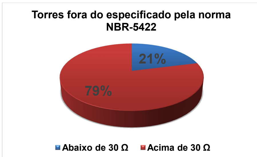
Gráfico 3: Torres fora do especificado pela norma NBR-5422
