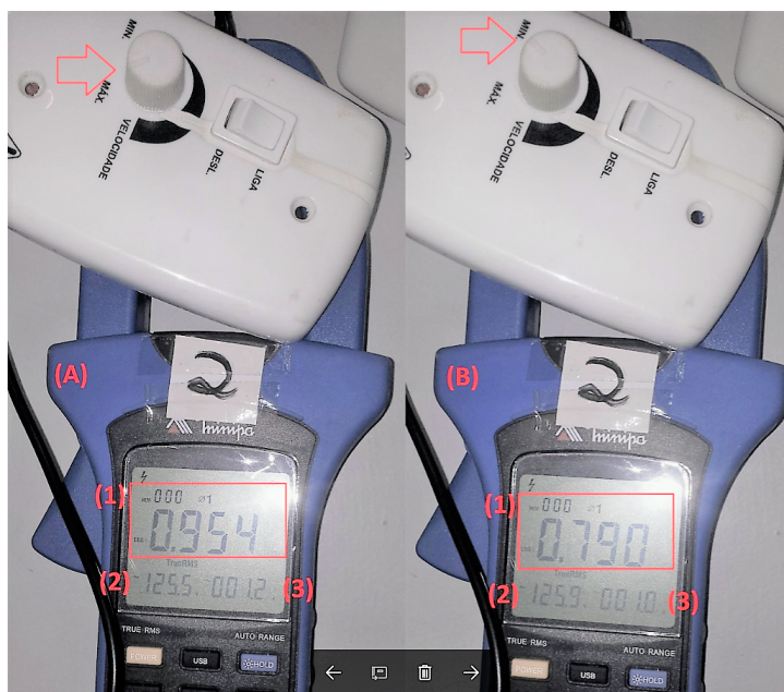
Figura 40: Aferindo a carga com o alicate amperímetro
