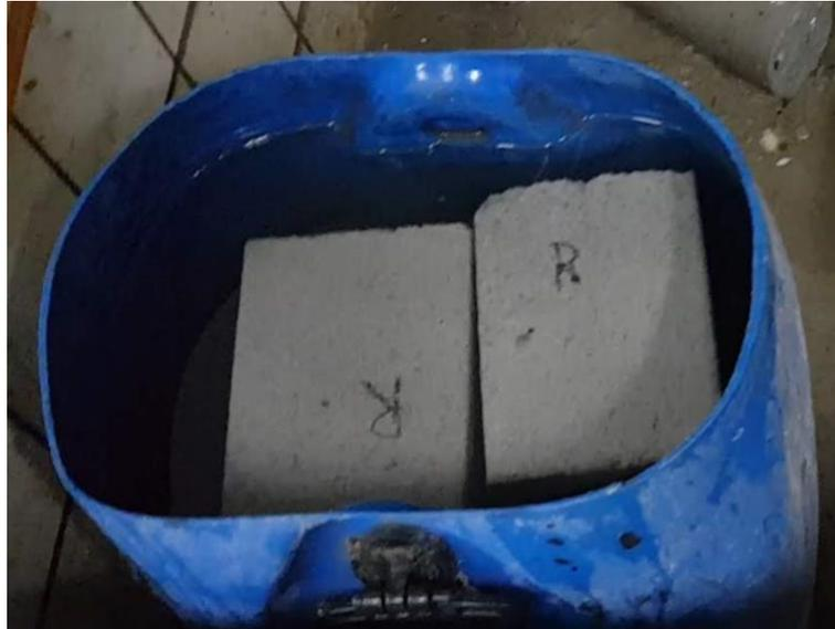
Figura 7. Teste de absorção de água (O Autor, 2019).
