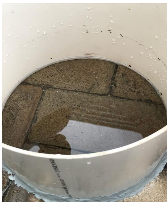
Figura 51: Ensaio de percolação na receita federal de Caratinga-MG
