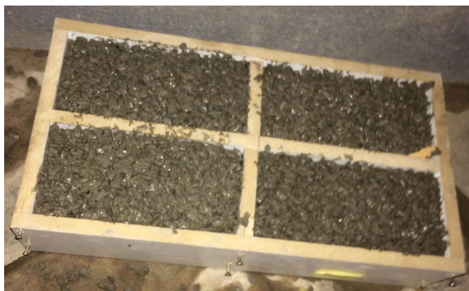
Figura 33: Corpo de prova do bloco em seu estado fresco
