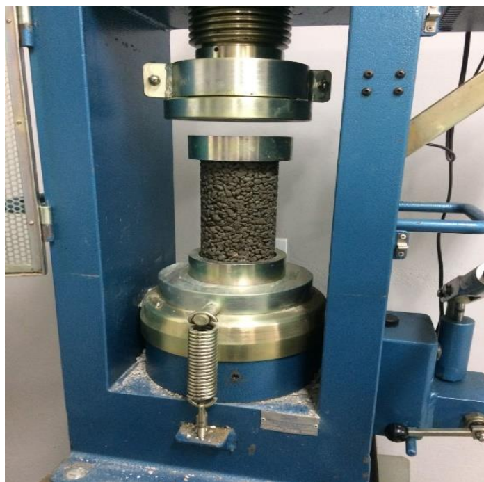
Figura 35: Corpo de prova aos 7 (Brita 0)
