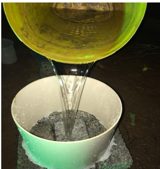
Figura 44: Ensaio em Campo, com a aplicação de blocos Inter travados.
