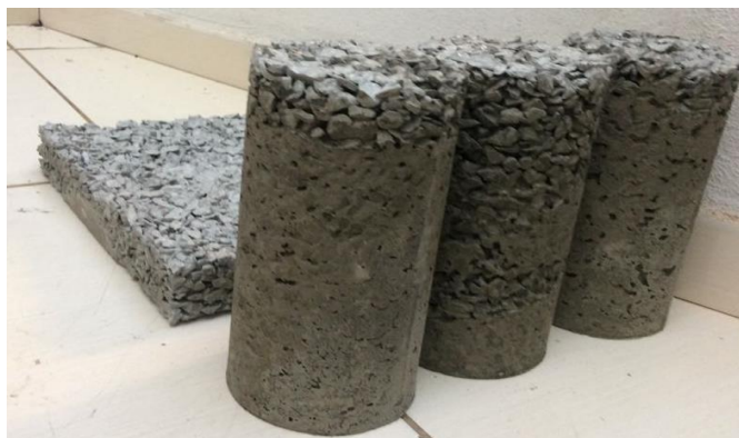
Figura 27: Amostra do primeiro ensaio, usando somente brita 0
