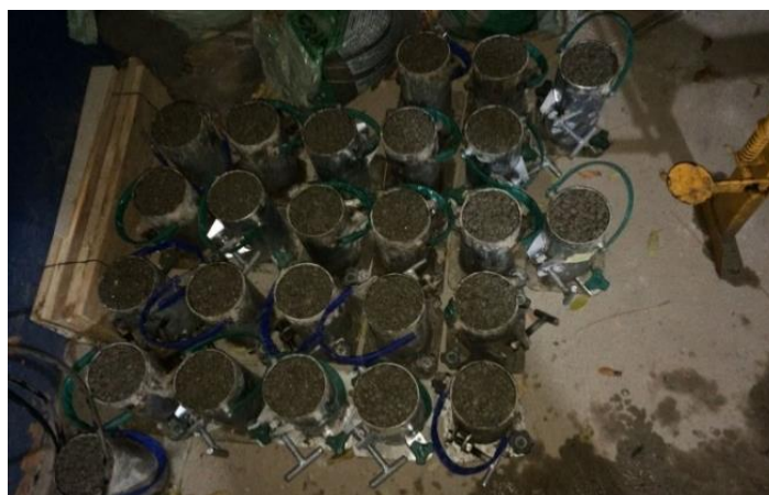
Figura 32: Corpo de prova cilíndrico em seu estado fresco
