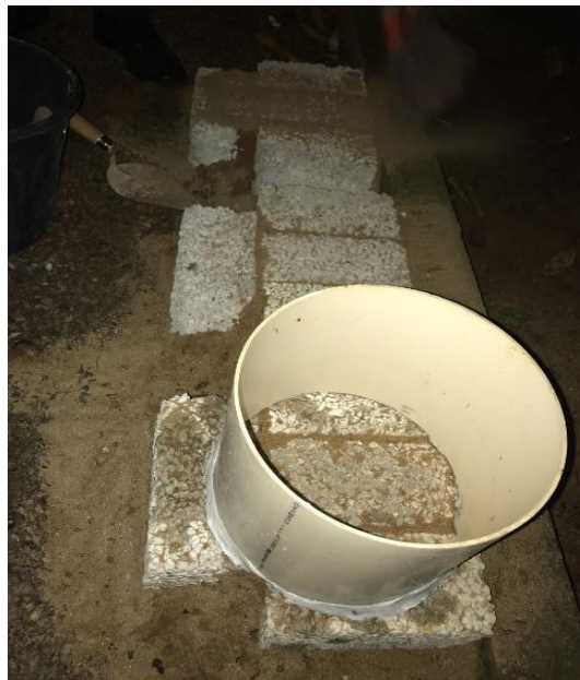
Figura 45: Aplicação da areia no rejunte nos blocos para o ensaio de percolação
