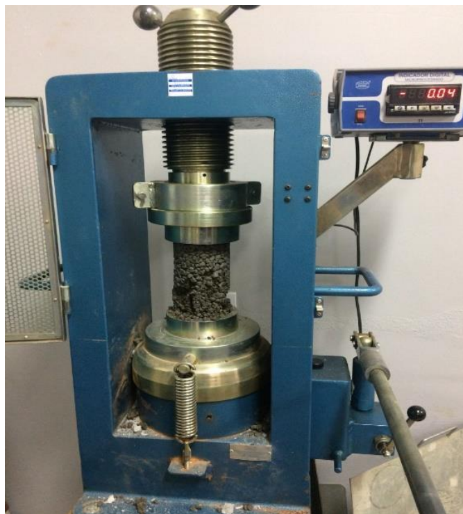
Figura 36: Corpo de prova rompido com 14 dias (Mista 50%)
