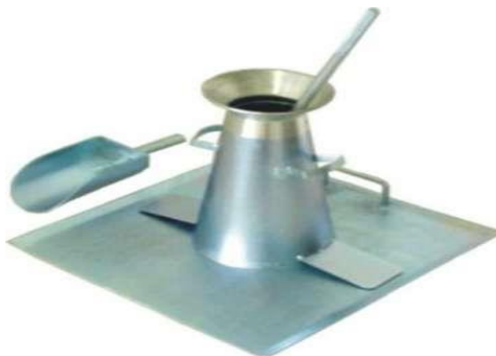
Figura 29: Objetos usados para o ensaio no Slump Test
