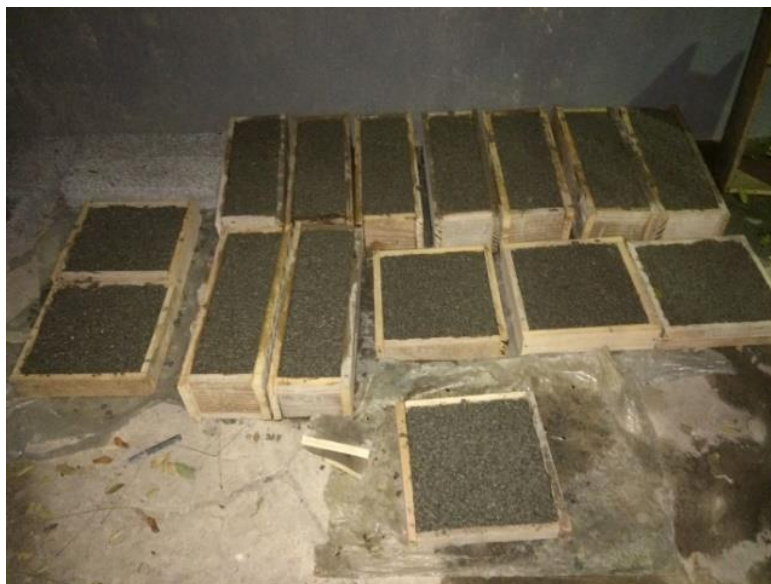
Figura 34: Corpos de provas prismáticos para o ensaio de tração na flexão e placas de concreto
