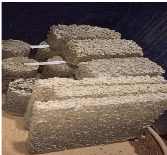
Figura 28: Os três agregados usados como o mesmo traço para o concreto permeável
