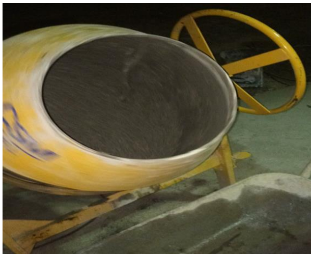
Figura 22: Mistura de todos os componentes no concreto permeável
