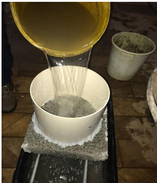
Figura 43: Ensaio de percolação da placa de concreto permeável em laboratório
