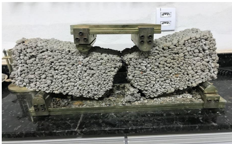
Figura 40: Corpo de prova prismático aos 14 dias, rompido no 1/3 interno do bloco.
