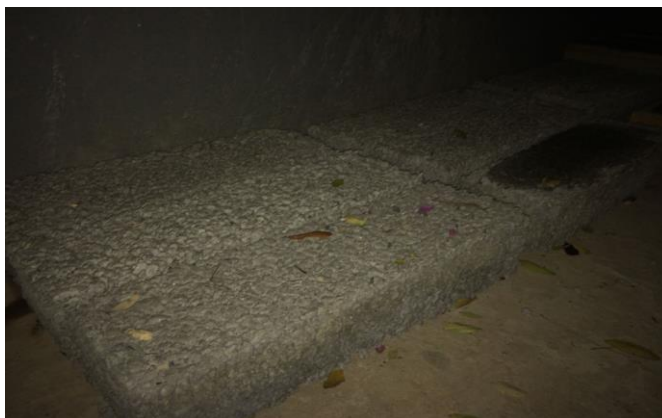
Figura 24: Modelo de concreto permeável após 24 h de prepara já desenformado, formato prismático
