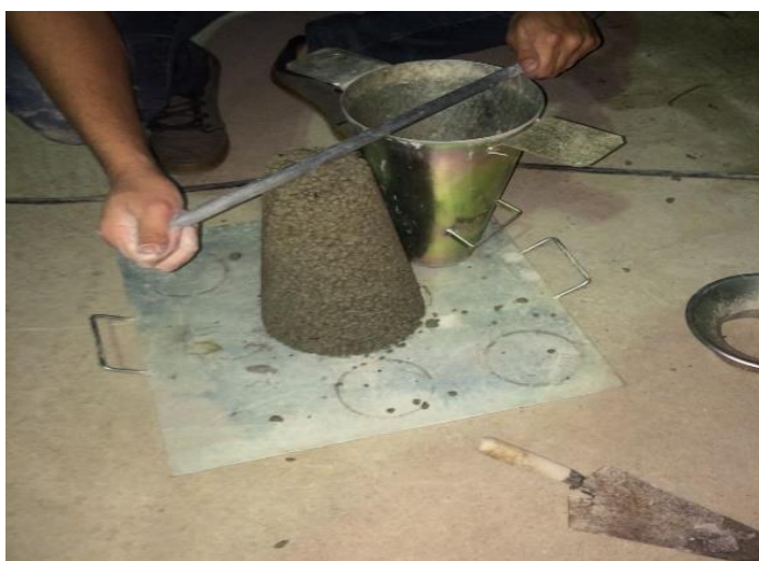
Figura 30: Execução do Slump Test
