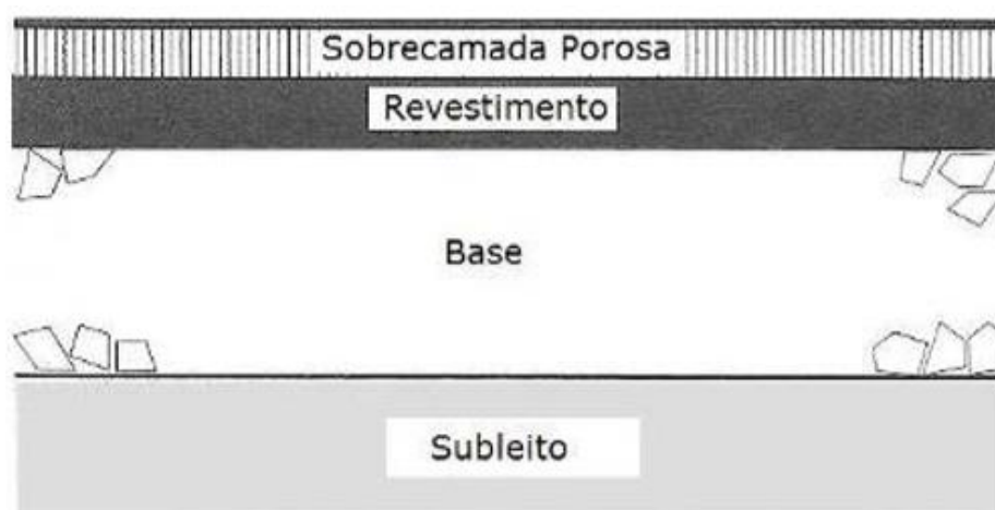
Figura 21: Sobre camada porosa aplicada no revestimento convencional
