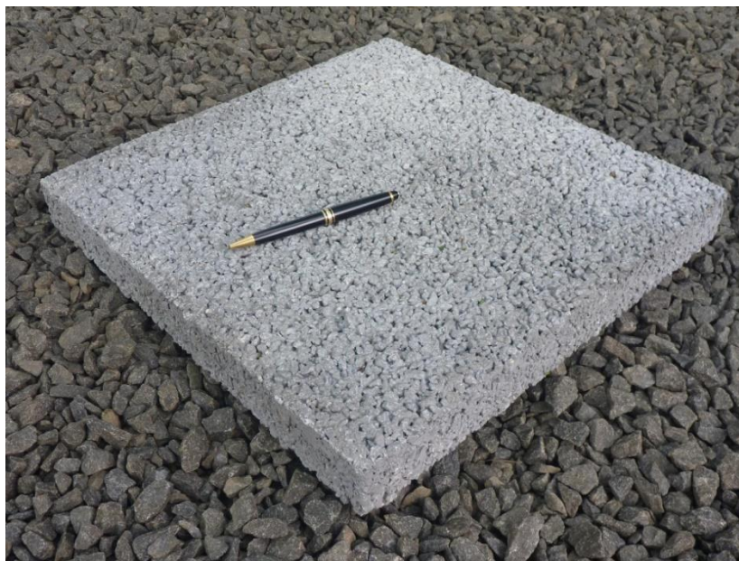
Figura 3: Amostra de uma placa do concreto permeável
