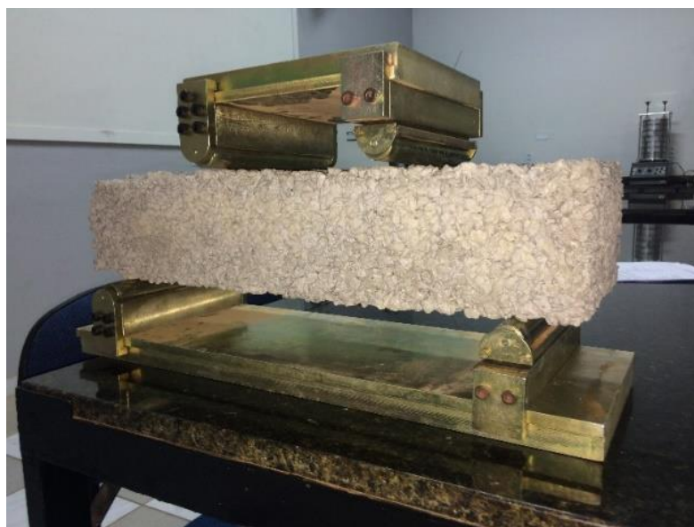
Figura 38: O bloco já colocado na plataforma bi apoiada
