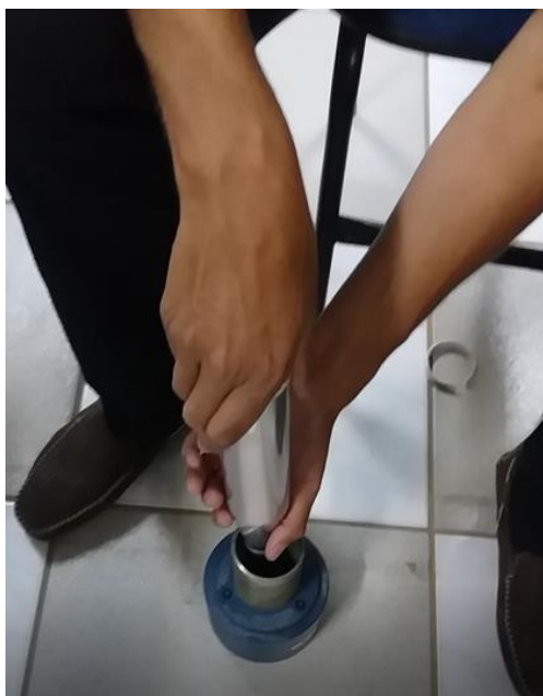
Figura 3.5: Aferição do aparelho de esclerômetria em uma bigorna de aço.
