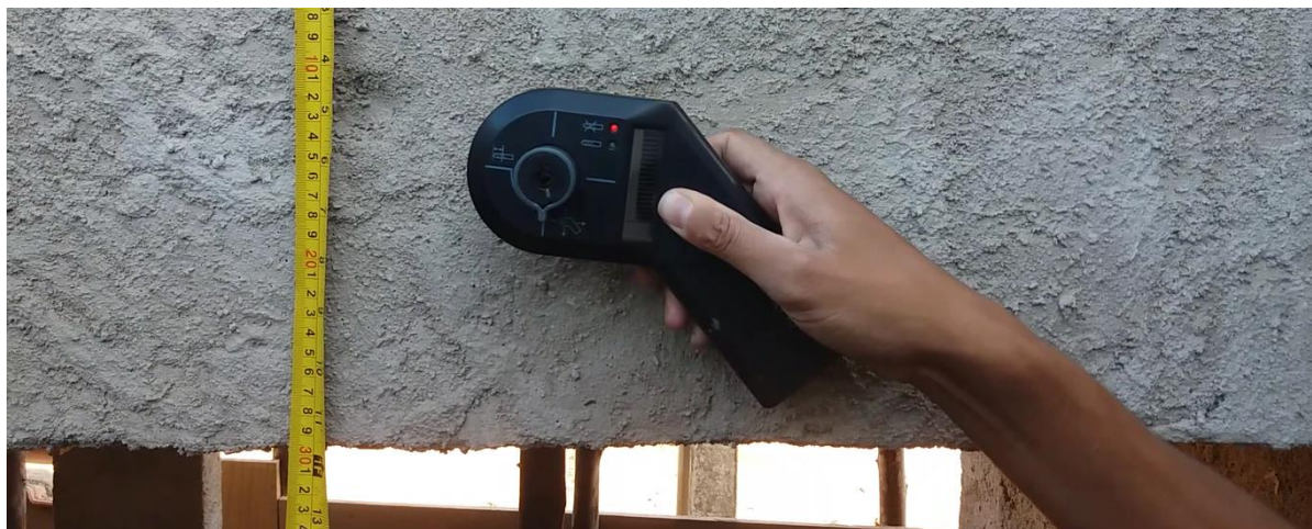
Figura 5.4: Localização por ensaio de pacômetria das barras posicionadas próximo a linha neutra do elemento.
