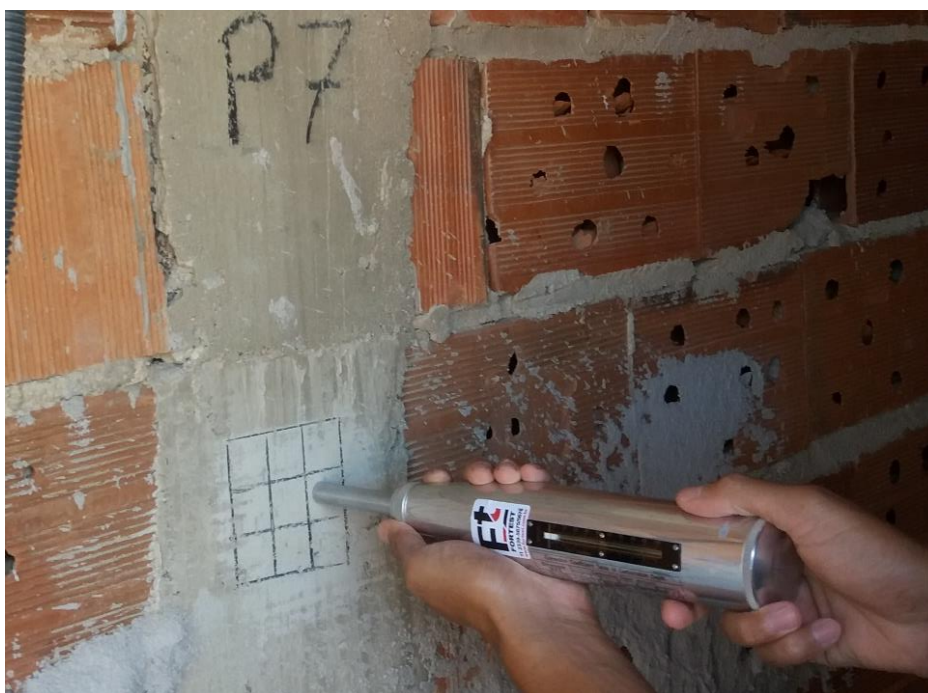
Figura 3.6: Marcação dos pontos para análise de esclerometria.
