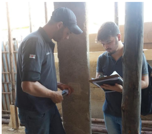
Figura 3.7: Ensaio de esclerometria em um pilar.
