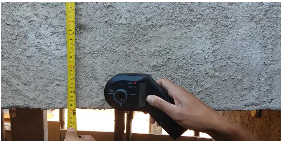
Figura 3.4: Aparelho pacômetro identificando presença de aço.
