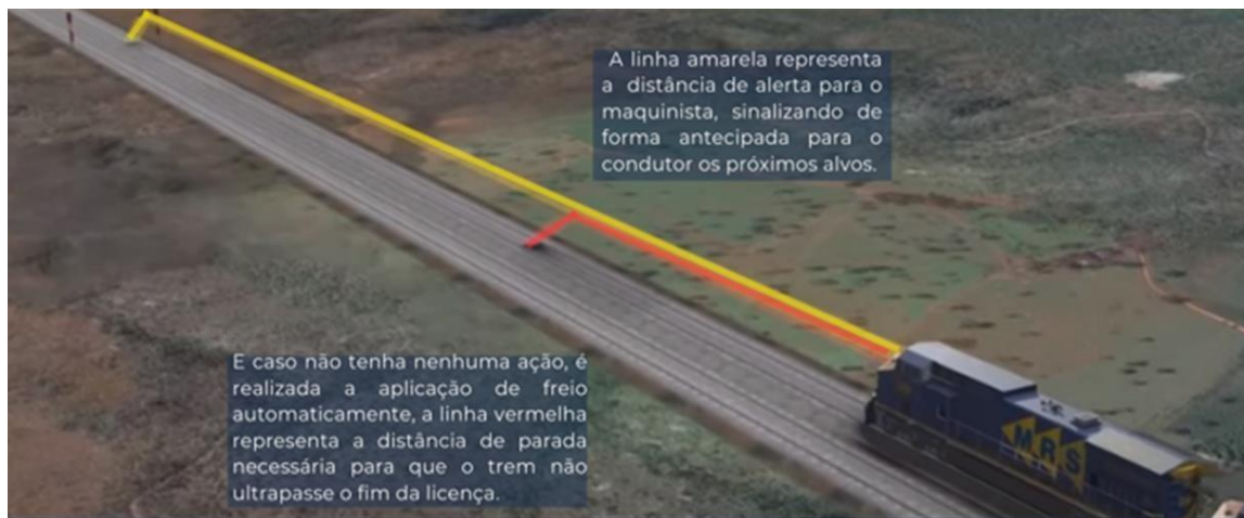
Figura 22 – Distância de alerta e frenagem automática
