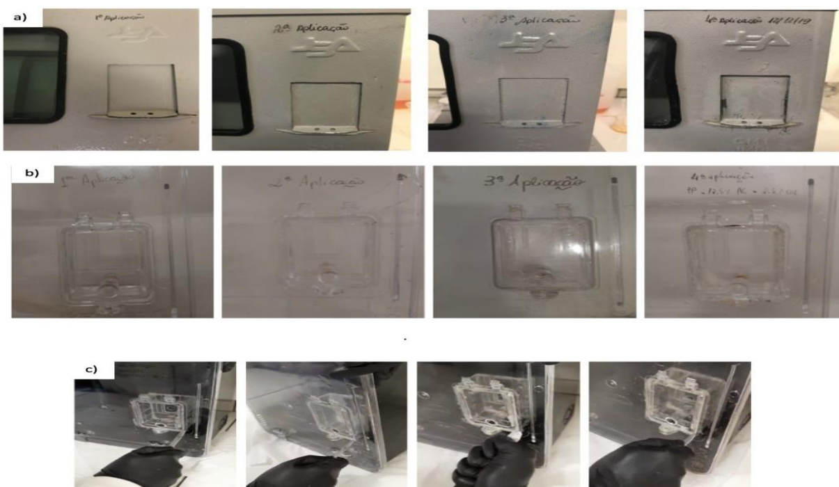
Figura 10 - Sucessivas aplicações do adesivo na caixa a) de metal, b) de acrílico e remoções na caixa de acrílico c).
