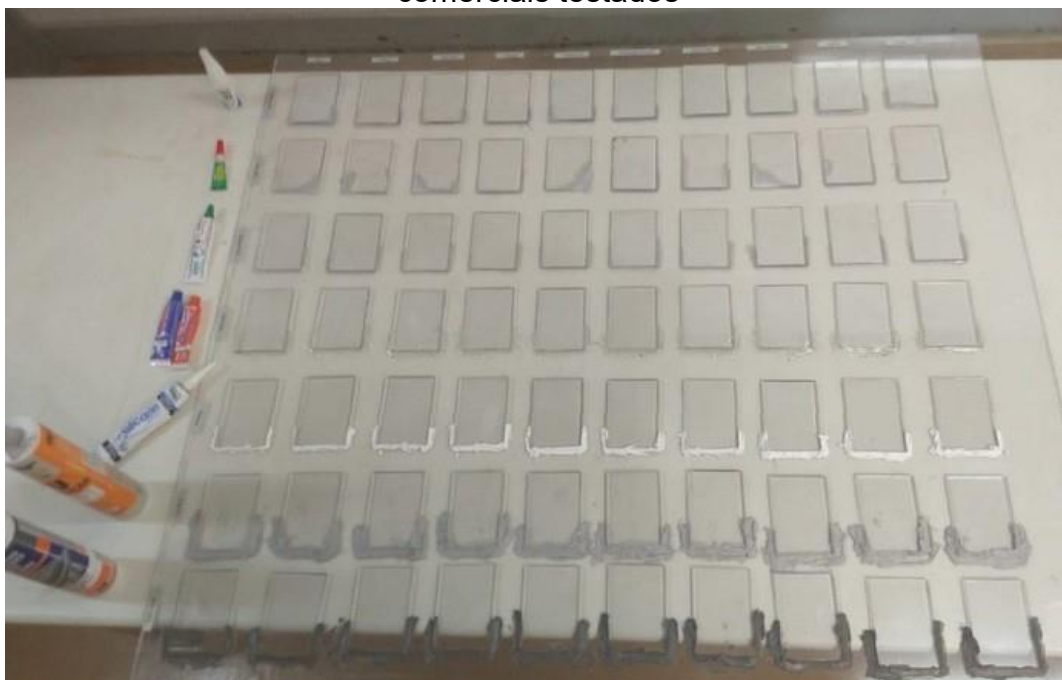
Figura 3 - Fotografia da placa de policarbonato mostrando a aplicação dos adesivos comerciais testados
