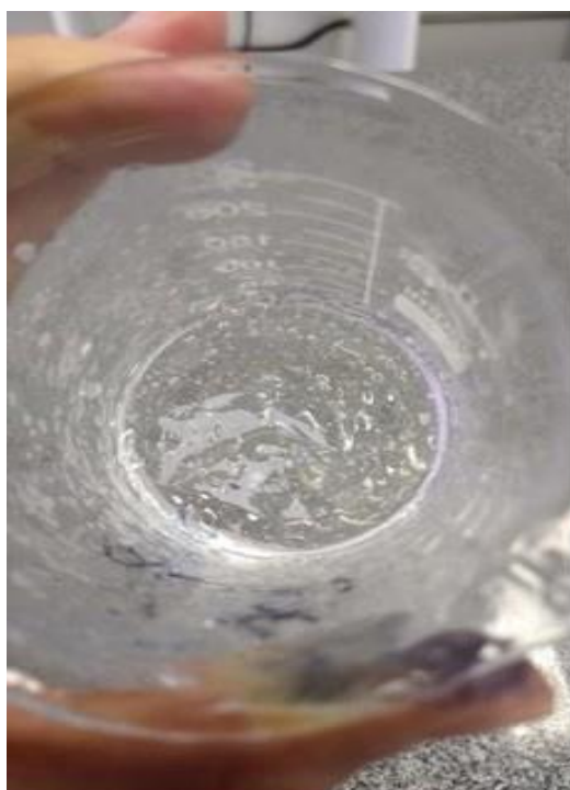
Figura 9 - Formação de gel do removedor específico.
