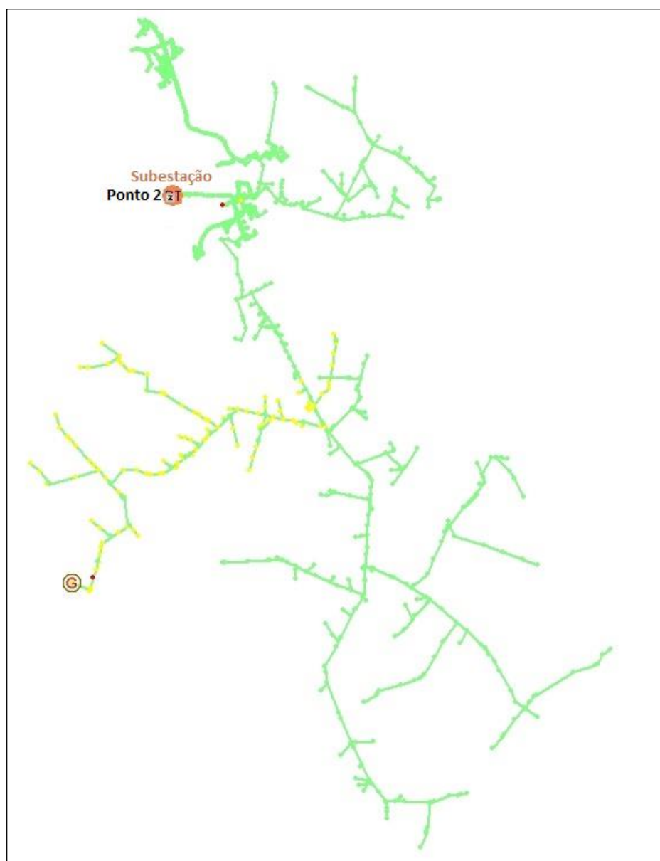
Figura 10 – Instalação do RT em ponto ótimo
