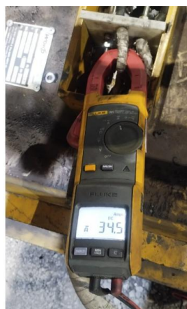
Figura 11, 12 e 13 : Medição da Resistência 3,8Ω, Corrente 34,5ª e Tensão 110,5VDC
