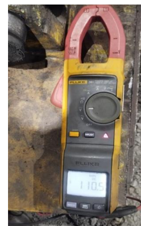
Figura 11, 12 e 13 : Medição da Resistência 3,8Ω, Corrente 34,5ª e Tensão 110,5VDC
