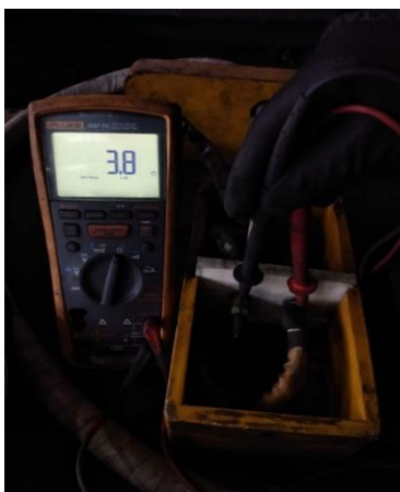
Figura 11, 12 e 13 : Medição da Resistência 3,8Ω, Corrente 34,5ª e Tensão 110,5VDC
