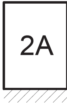
Figura 21 - Laje engastada com 3 bordas simplesmente apoiadas
