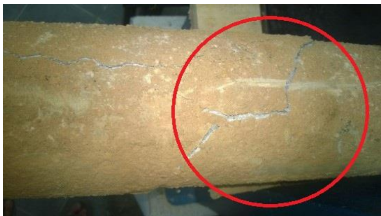
Figura 12: Ruptura do corpo de prova após ter ultrapassado o limite da tensão máxima admissível. Fonte: Arquivo pessoal.
