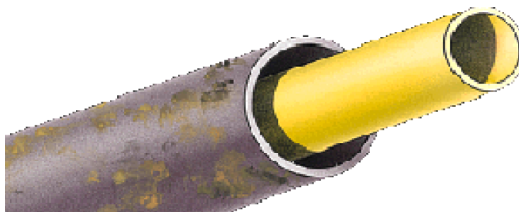
Figura 5: Tubulação após a substituição pelo método simples. Fonte: GRILO, 2007.
