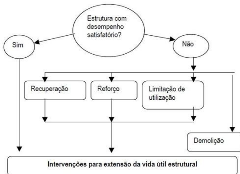
Figura 03 – Hipótese para recuperação de estruturas.
