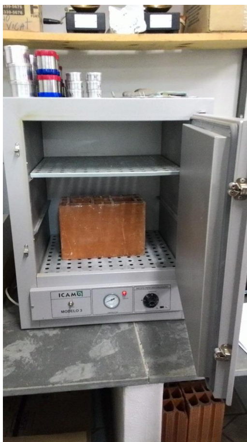
Figura 32 - Secagem em estufa do bloco cerâmico estrutural Fonte: Acervo do autor
