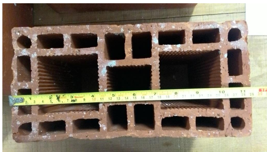
Figura 23 - Obtenção do comprimento (C) do bloco cerâmico em laboratório
