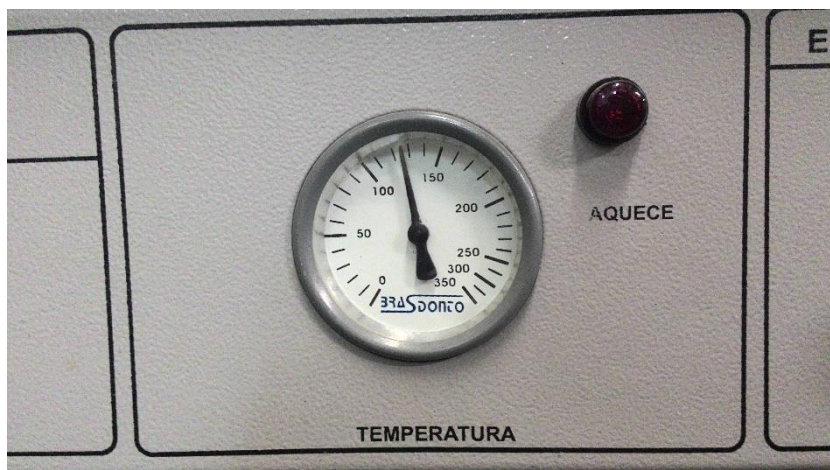
Figura 33 - Controle de temperatura para secagem do bloco cerâmico estrutural Fonte: Acervo do autor
