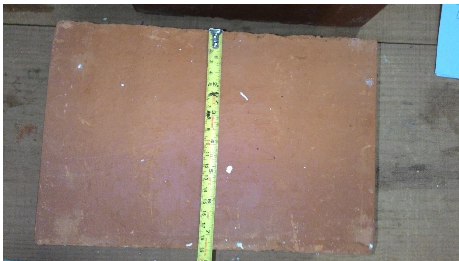
Figura 24 - Obtenção da altura (H) do bloco cerâmico em laboratório Fonte: Acervo do autor
