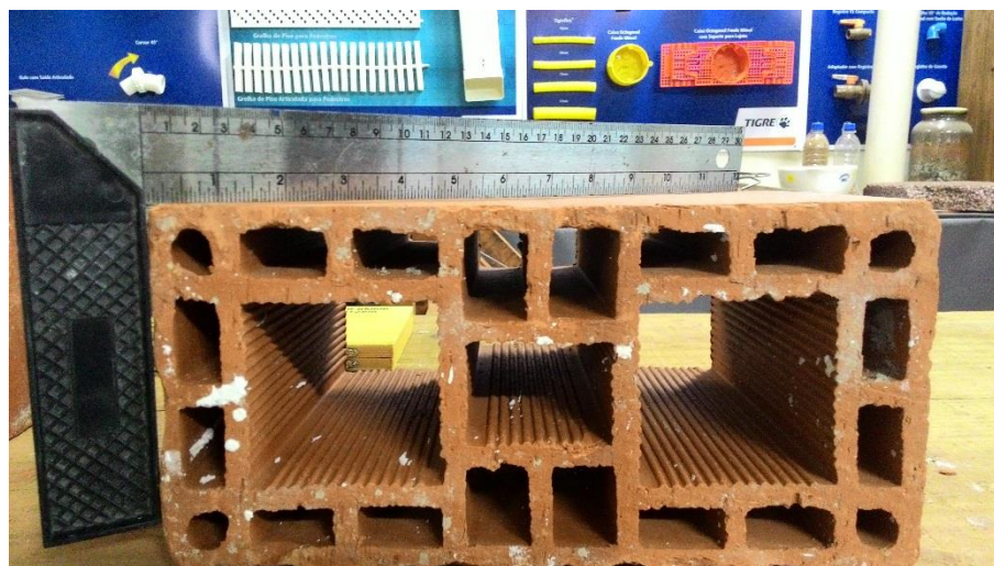
Figura 29 - Verificação da planeza das faces dos blocos cerâmicos Fonte: Acervo do autor
