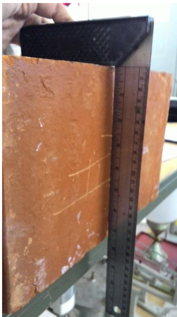
Figura 30 - Verificação dos desvios em relação ao esquadro Fonte: Acervo do autor
