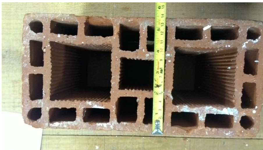
Figura 25 - Obtenção da largura (L) do bloco cerâmico em laboratório Fonte: Acervo do autor
