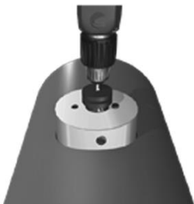
Figura 71 - Perfuração no coletor principal. Fonte: TIGRE, 2013.
