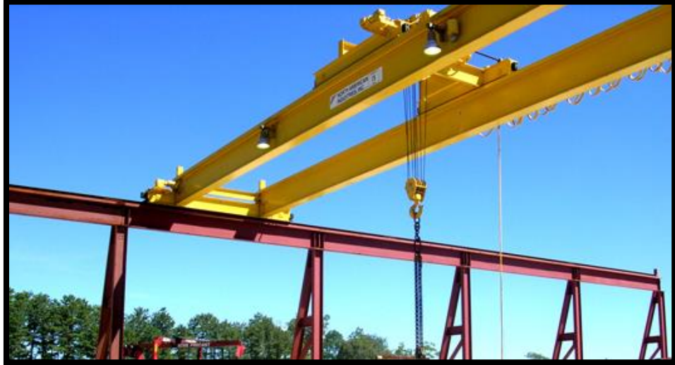
Figura 4: Ponte rolante dupla viga
