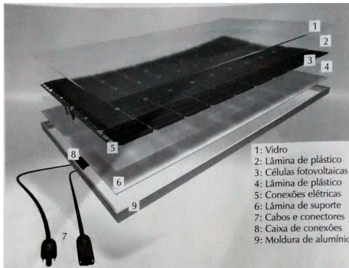
Figura 8: Componentes de um módulo fotovoltaico
