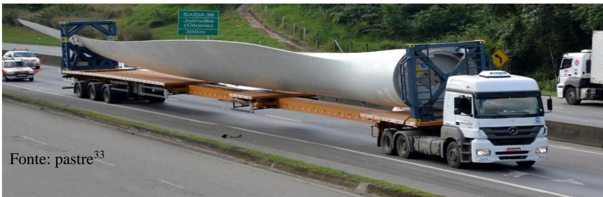
Figura 14 – Pá de aerogerador em transporte
