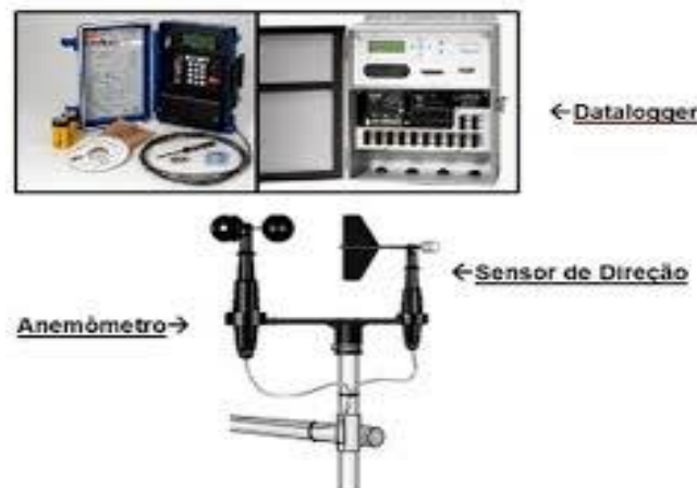
Figura 20 – Unidade de controle e medidores de velocidade e direção
