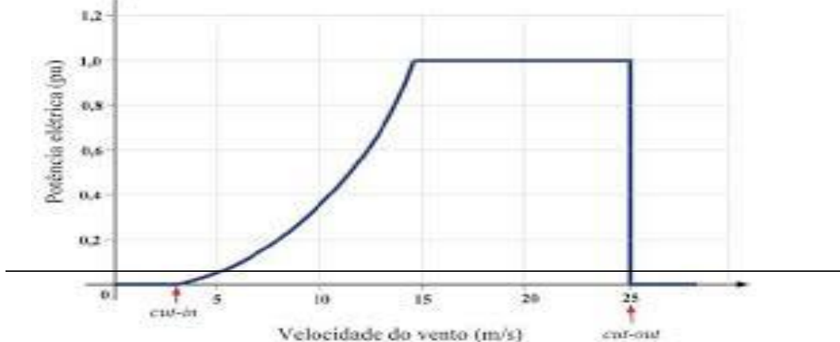
Figura 9 Curva de Potência típica de uma turbina eólica.
