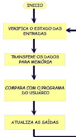
Figura 15: Ciclo de funcionamento de um CLP Fonte: (CARVALHO NETO, 2011, p. 8.) 42
