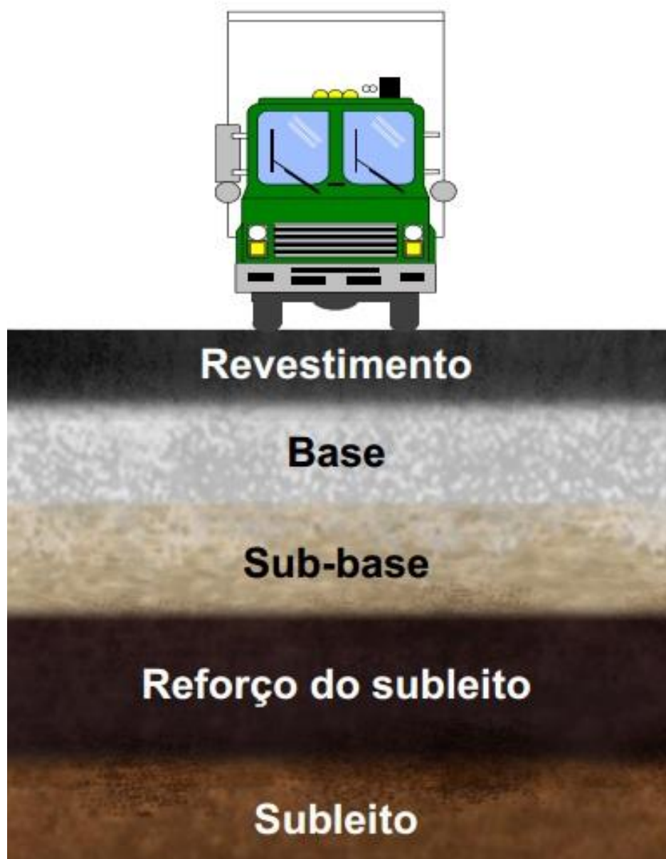
Figura 4. Esquema de camadas dos pavimentos flexíveis Fonte: (Associação Brasileira de Cimento Portland, sd.)
