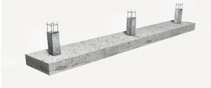
Figura 5 – Sapatas Contínuas<sup>12</sup>
