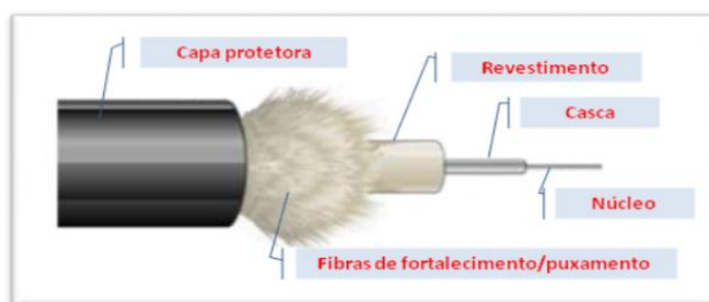
Figura 6: Estrutura de uma fibra óptica 98
