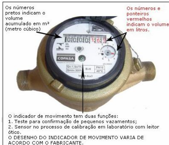
Figura 2.2 – Hidrômetro (COPASA, 2011)
