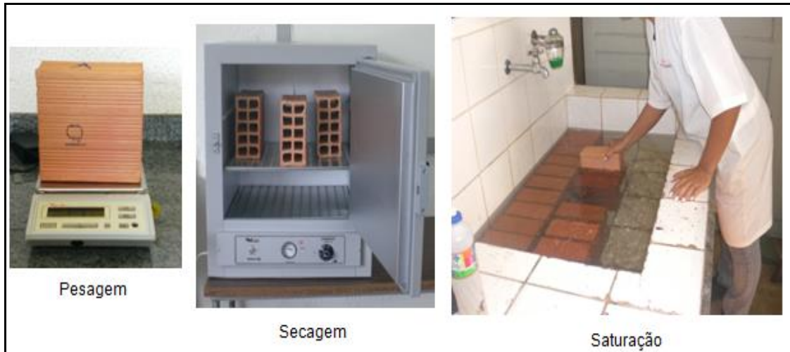
Figura 9- Absorção de água. Fonte: Laboratório de materiais UFV
