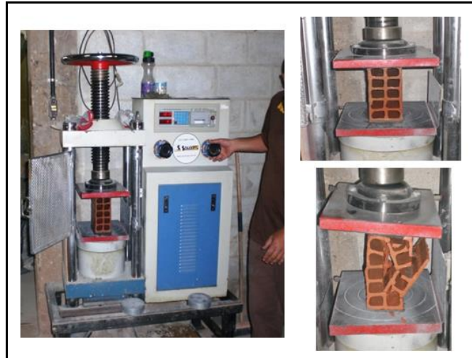
Figura 11- Resistência à compressão. Fonte: Laboratório de materiais UFV
