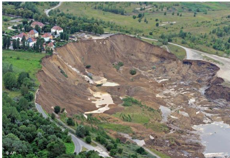
Figura 5 - Exemplo de escoamento ou rastejo. HORST (2007)
