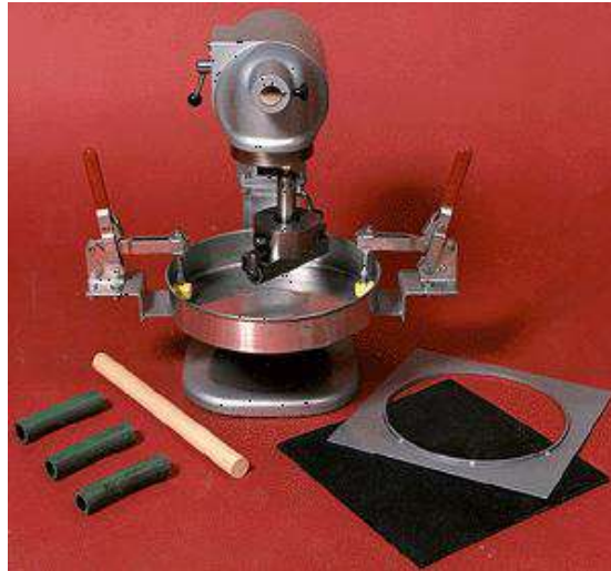
Figura 14: Equipamento utilizado no teste de resistência à abrasão (Lafarge Concreto, 2013)
