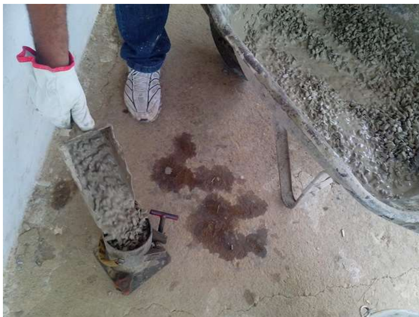
Figura 8: Moldagem do Concreto Permeável no Corpo de Prova (Fonte: Arquivo dos Pesquisadores)
