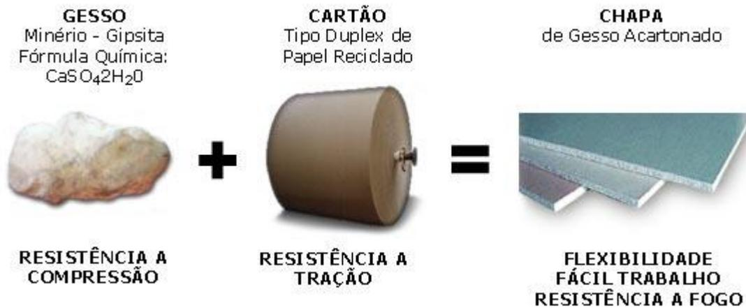
Figura 01 – Processo de fabricação das placas de gesso acartonado
