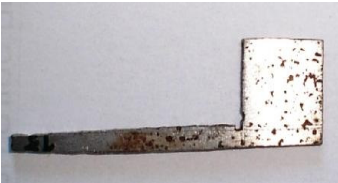
Figura 3 - Corrosão por Pite. Fonte: Associação Brasileira de Química
