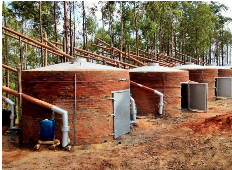
Figura 7 - Forno para carvão vegetal e extrato pirolenhoso
