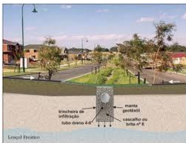
Figura 9 - Corte de uma trincheira de infiltração
