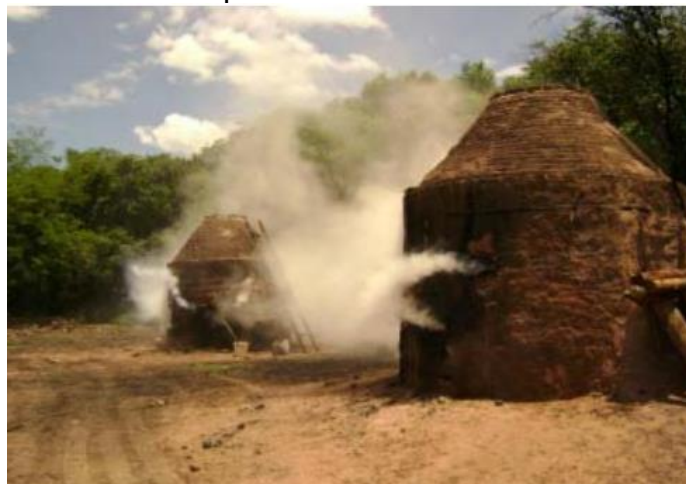
Figura 5 – Forno de queima de carvão vegetal não adaptado para extração do extrato pirolenhoso – Pelotas-RS
