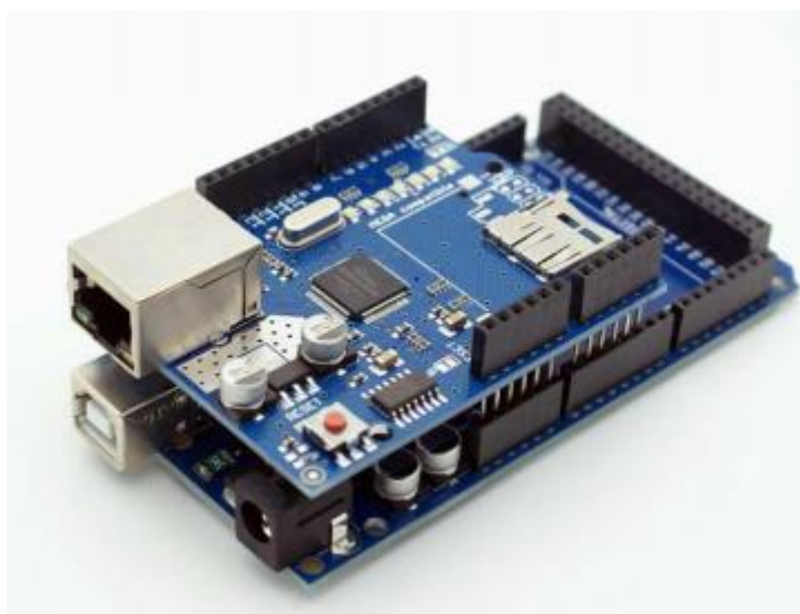
Figura 12: Shield Ethernet acoplado ao Arduino Mega
