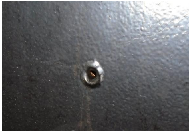
Figura 3: Tomada Winter Kenedy (Int. da Turbina)
