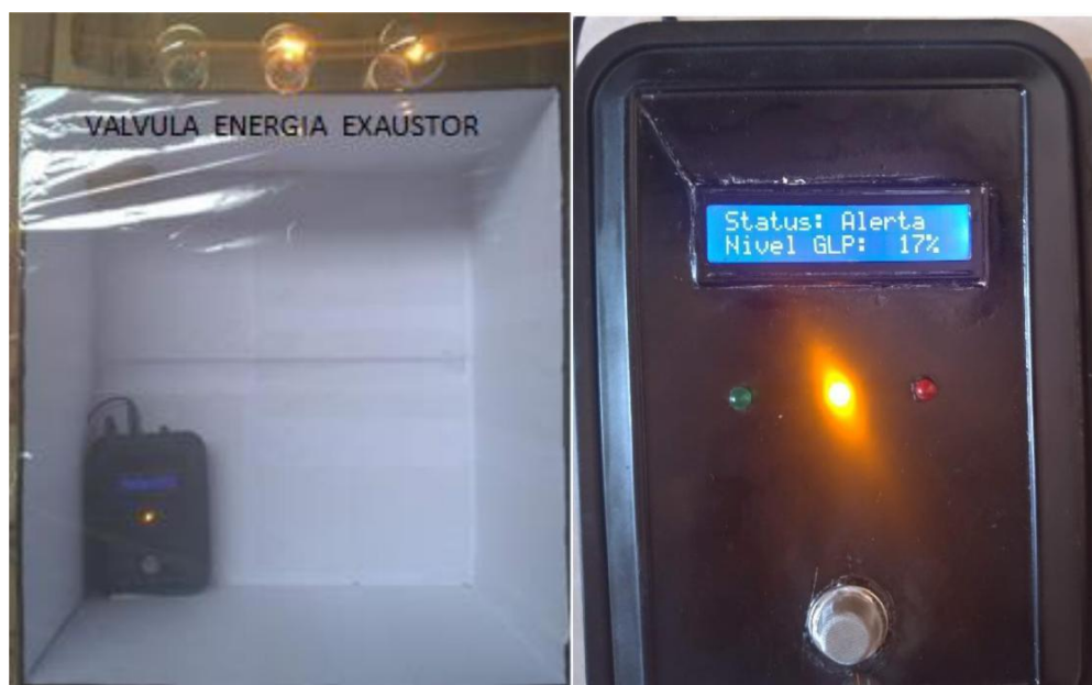
Figura 24 - Religamento da energia e exaustor acionado
