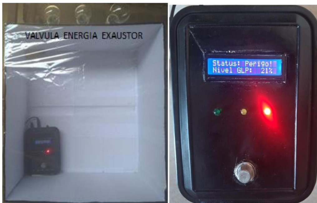
Figura 22 – Sidgap em estado de perigo
