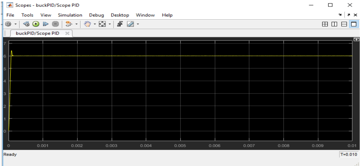
Figura 8: Simulação da tensão com entrada 24V (PID)
